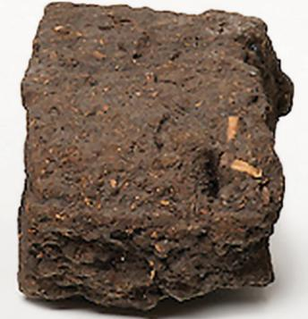
يعتبر الفحم الصلب أنظف أنواع الفحم من حيث الحرق، حيث ينتج حرارة أكثر ودخان أقل من أنواع الفحم الأخرى، ويستخدم بكثافة في الأفران التي تعمل يدويا. وما تزال بعض نظم الأفران المنزلية تستخدم الفحم الصلب الذي يحترق لفترة أطول من الخشب. وأطلق المهندسون على الفحم الصلب هذا الاسم لأنهم استخدموه وقودا للقطارات.
